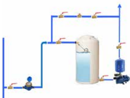
نصب معمول پمپ های آبرسانی
